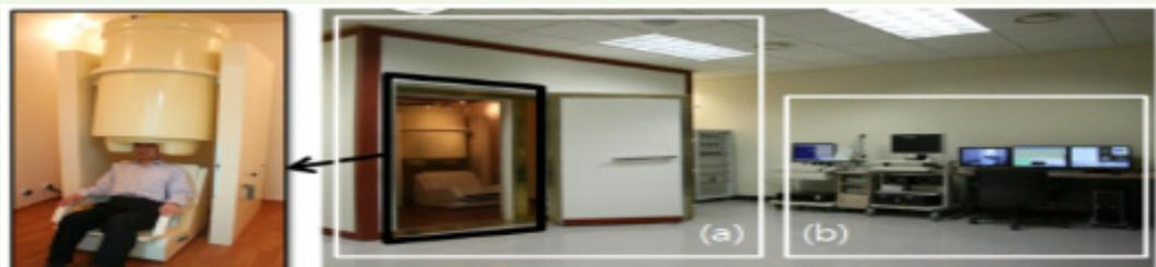
임상시설에 설치된 한국형 뇌자도 자기차폐실 내부 피험자 측정 준비 상태(왼쪽)
